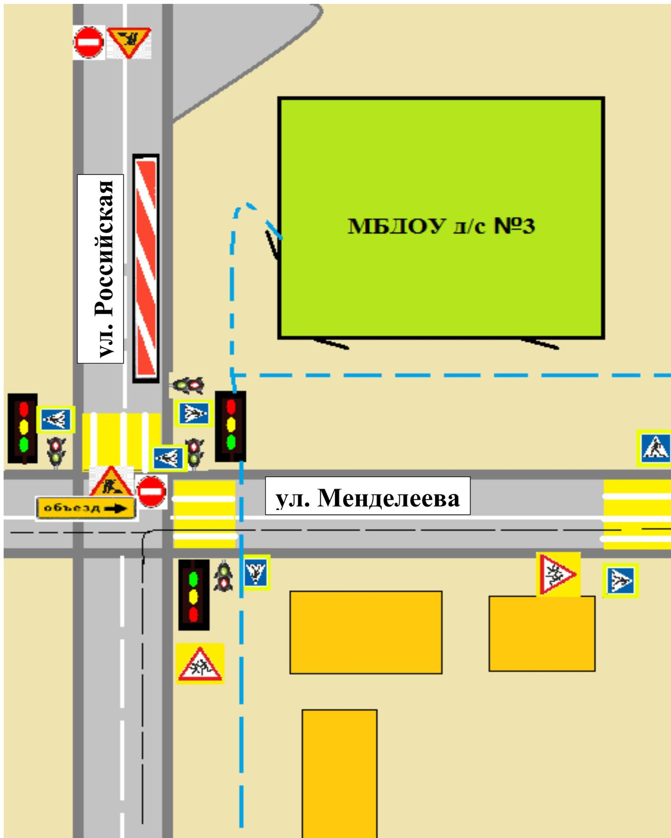
На схеме указано место производства дорожных ремонтно-строительных работ, его обустройство дорожными знаками и ограждениями, иными техническими средствами организации дорожного движения, а также безопасный маршрут движения детей к образовательной организации с учетом изменения маршрута движения по тротуару.
